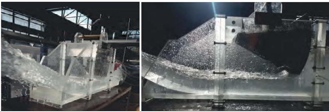
Abbildung 72: Dreiteiliges Bauwerksmodell aus Plexiglas mit Radialschütz und Druckmessbohrungen (Maßstab 1:51,25)
