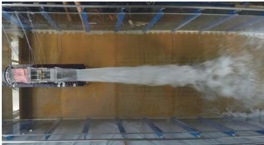
Abbildung 74: Versuchsstand physikalisches Modell in Laborrinne
