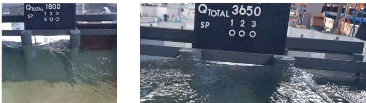
Abbildung 21: Oberstromseitige Wasserspiegellagen und (An-)Strömungsmuster ausgewählter Lastfälle
