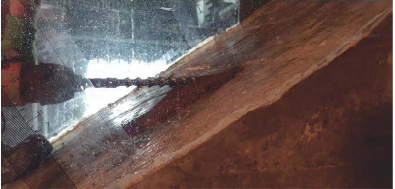
Abbildung 36: Einbringen der Wühlerschäden mittels Handschlagbohrmaschine
