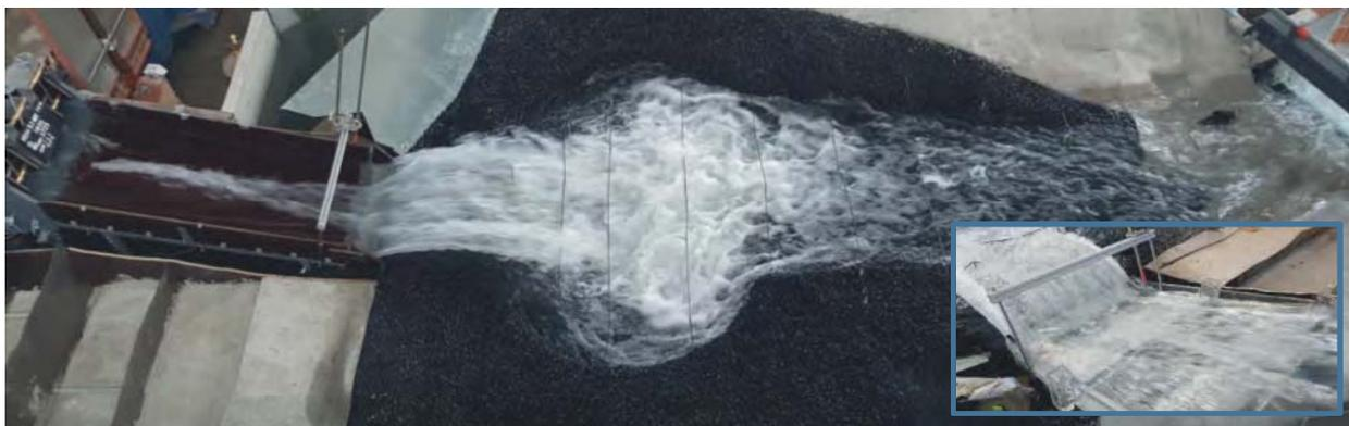
Abbildung 23: Modellbetrieb: (n-1)-Lastfall und resultierende Kolkung
