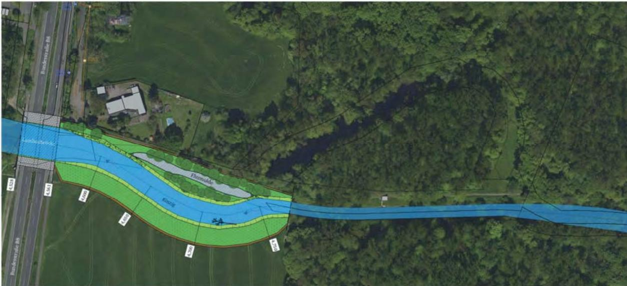
Abbildung 8: Maßnahmenplan des ersten Bauabschnittes (km 4,528 bis km 4,735, ohne Legende, in Anlehnung an ArchiCAD Studentenversion, eigene Darstellung)
