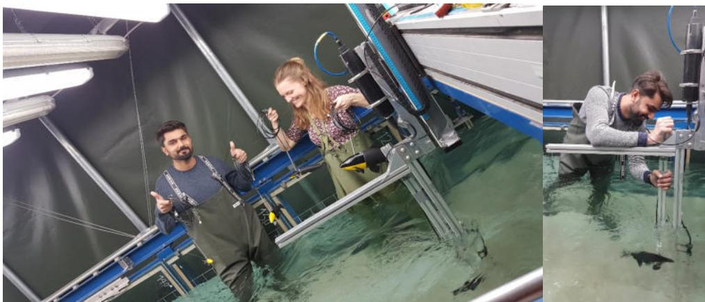
Abbildung 28: Erste Tests zum Einsatz der Fischeinmesssonden sowie zur Beeinflussung der Strömung durch den Fischkörper im Rahmen des Projektes *MeMo Fischabstieg* im wasserbaulichen Forschungslabor
