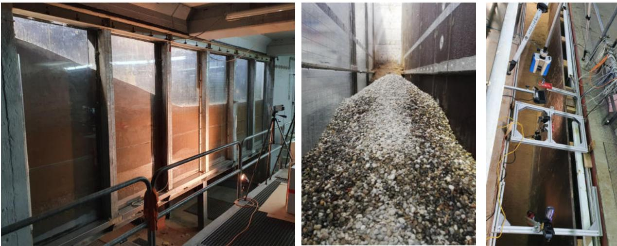
Abbildung 44: Links: eingebauter Deichquerschnitt mit Ansicht durch das Beobachtungsfenster, mitte: Einbau des Keshügels zur Bildung des Luftpolsters, rechts: Oberhalb der abgedeckten Tiefrinne angeordnete Messtechnik
