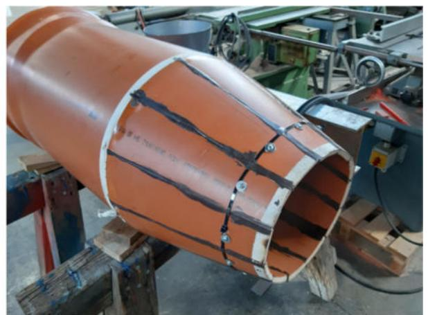
Abbildung 35: PVC-Rohr mit ausgeschnittenen Segmenten (links); Stabilisierung und Abdichtung (rechts)
