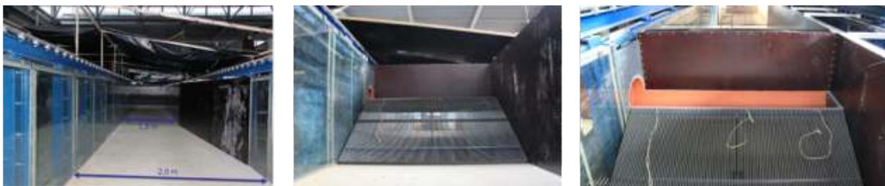
Abb.1: links: 40 m Rinne mit Einengung, Mitte: Flachrechen, rechts: Abspülrinne mit Bypass und Abspülrinnenwand, Quelle: Autor
