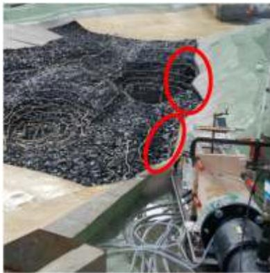
Abbildung 11: Einfluss des Entlastungsstrahls in Achse 2 auf die böschungsnahen Bereiche.
