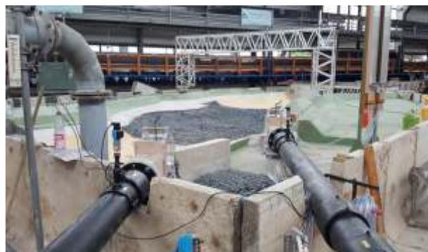
Abbildung 8: Reservoir-Abschnittmodell Fierza: Blickrichtung nach unterstrom entlang der Tunnelachsen der Entlastungsbauwerke
