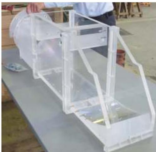
Abbildung 2: Auslaufbauwerk mit abschließender Sprungschanze zum Strahlabwurf
