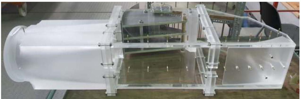
Abbildung 4: Blick auf die Unterseite eines Auslaufbauwerks: Anordnung der Druckmessstellen entlang der Sohllinie und der Seitenwand
