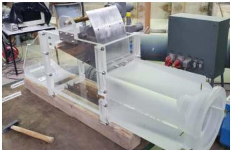
Abbildung 3: Verzugsstück, geöffnetes Radial-Segmentschütz und anknüpfende Sprungschanze des Auslaufbauwerks
