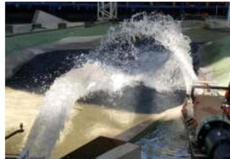
Abbildung 13: Seitliche Strahlablenkung und erzwungene Aufweitung am Bauwerk in Achse 2
