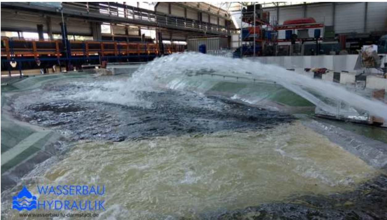
Abbildung 1: Blick in Strömungsrichtung unterstromseitig vom Fierza-Damm - 2 Auslässe in Betrieb
