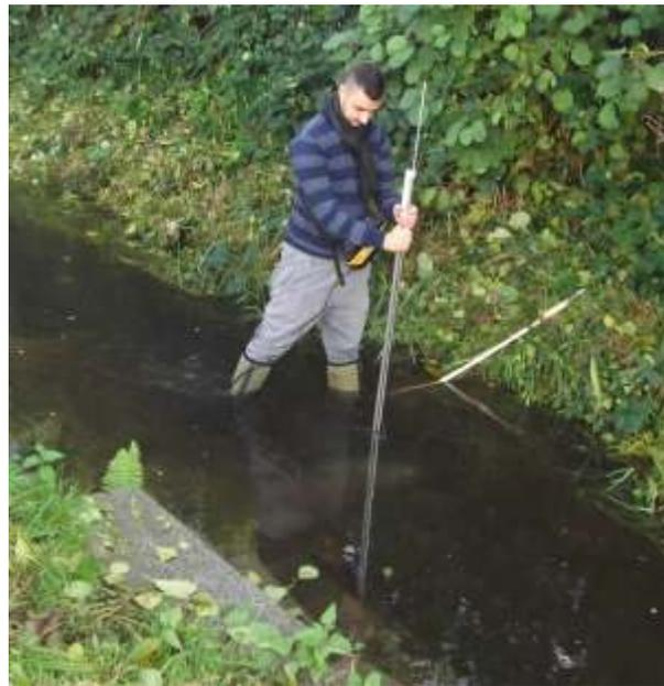
Abbildung 5: Fließgeschwindigkeitsmessung im Fischbach (Okt. 2016, Foto: L. Fonseca)
