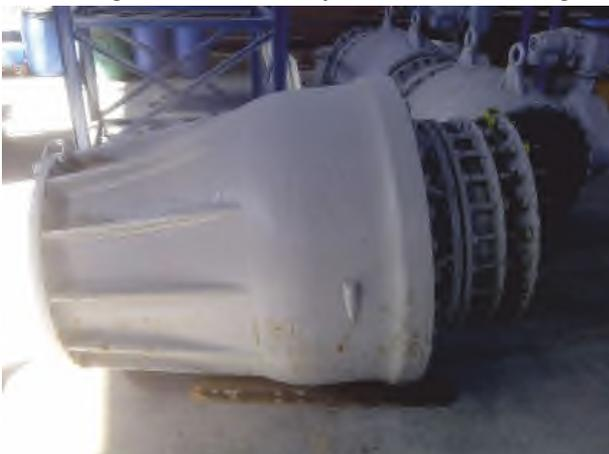
ausgebauter Rückflussverhinderer DN700 (Seitenansicht)
