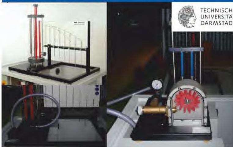
*Ausfluss aus einem Gefäß und Funktionsprinzip einer Pelton-Turbine*
