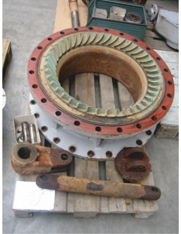
Ringkolbenschieber DN 700 (teilzerlegt)
