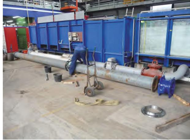
Anschluss der neuen Etanorm-Pumpe an die 40m-Rinne
