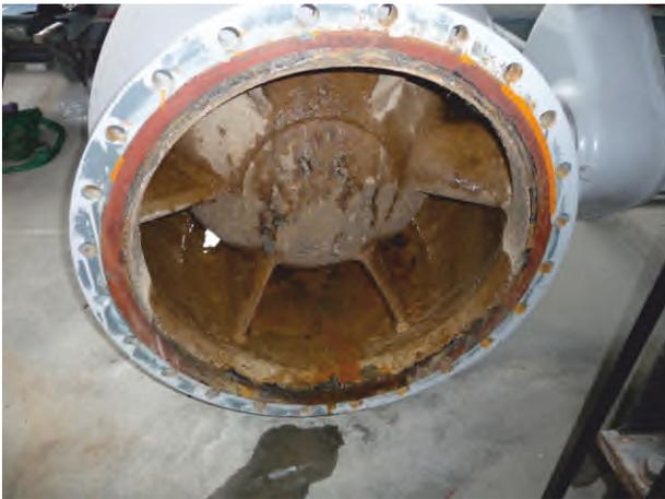
ausgebauter RiKo-DN700 (Zuströmseite)
