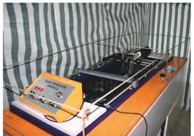
*Hydrogen Bubble Flow Visualisation System: Strömungsvisualisierung*
