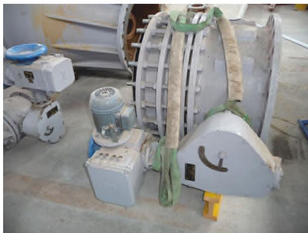
ausgebaute Absperrklappe DN 700
