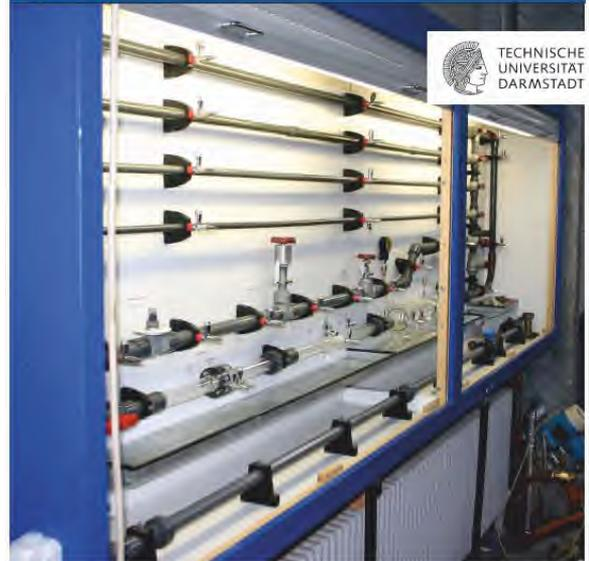
*Fluid Friction Apparatus: Rohrhydraulik, Reibungsverluste, lokale Verluste, Durchflussmessung*
