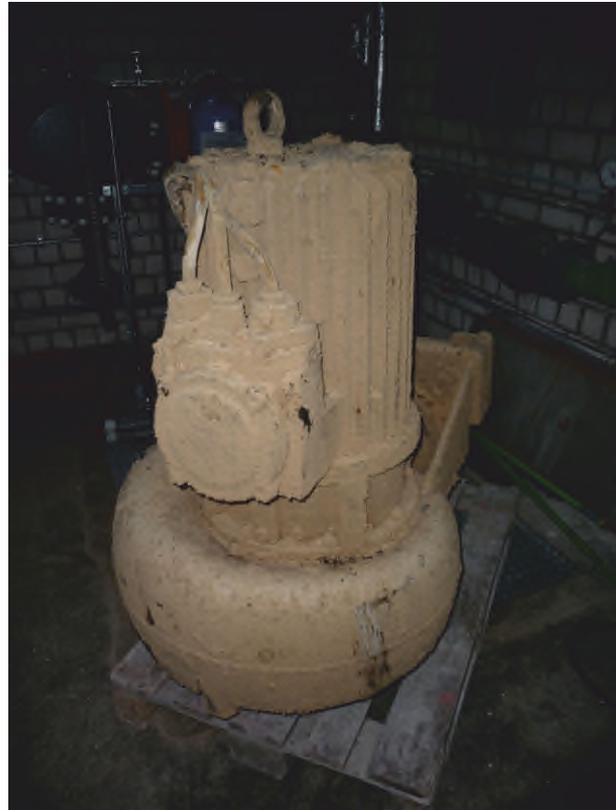
*Tauchmotorpumpe KRTUK (Pumpe 2)*
