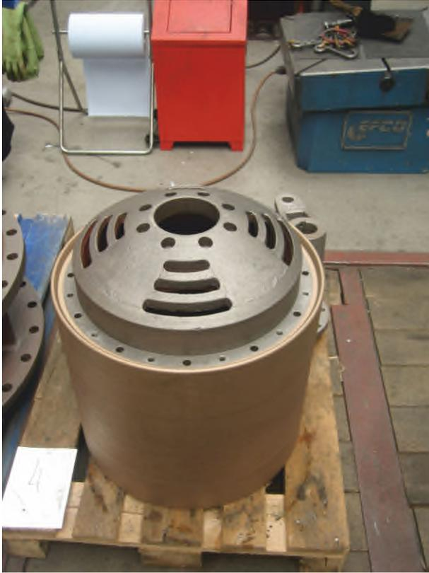
Ringkolbenschieber DN 700 (teilzerlegt)
