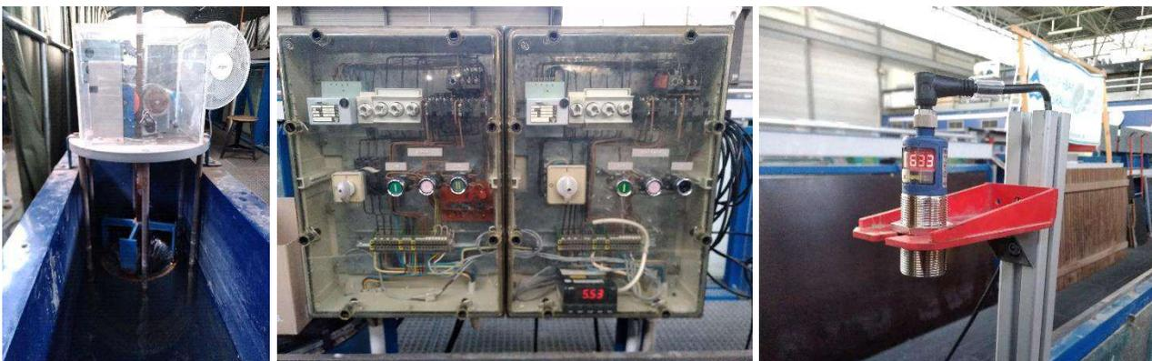
Abbildung 20: Das Zylinderschütz am Rinnenauslauf (links), die Steuerung (mitte) sowie der Ultraschall-Distanzmesser (rechts)
