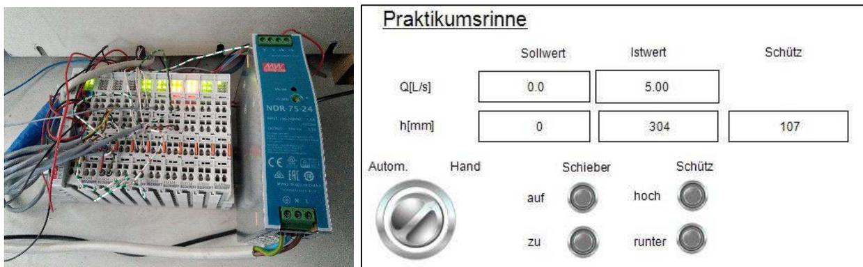
Abbildung 21: Die speicherprogrammierbare Steuerung (SPS) zur Signalverarbeitung (links) und die grafische Benutzeroberfläche auf der Steuersoftware (rechts)
