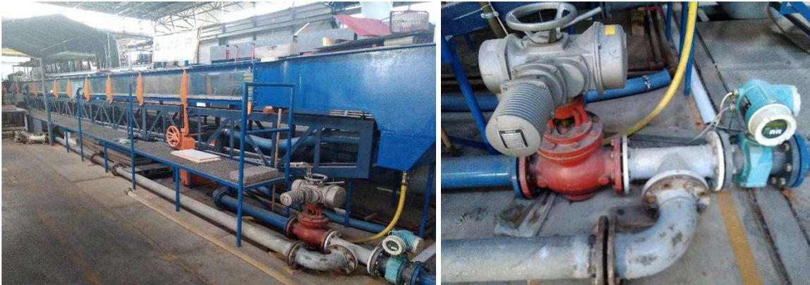
Abbildung 19: 12 m-Praktikumsrinne mit Einlaufbasin, Fließstrecke und Auslaufbereich (links) sowie in der Zulaufleitung installierter Schieber mit Durchflussmessgerät MID (rechts)
