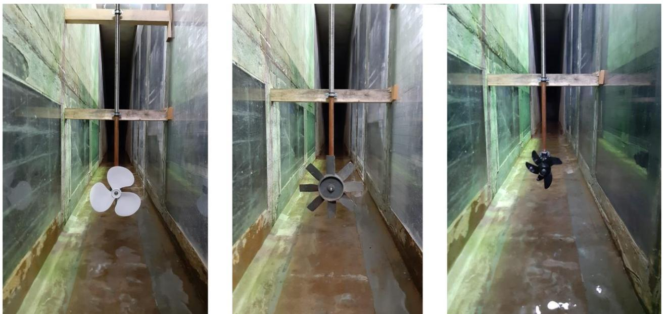
Abbildung 48: In der Tiefrinne verbauter Bootsmotor mit unterschiedlichen Rotoren. Links: Propeller aus einem Ventilator, Mitte: Propeller aus einem Gewächshauskühler, rechts: doppelter Propeller aus einem Bootsmotor
