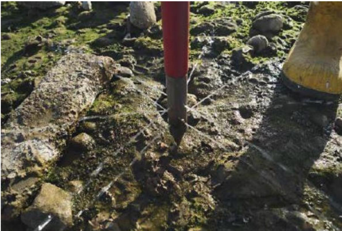
*Abbildung 35: Kolmameter mit perforierter Spitze bei Messung an Luft (Quelle: Stein et al. 2018)*
