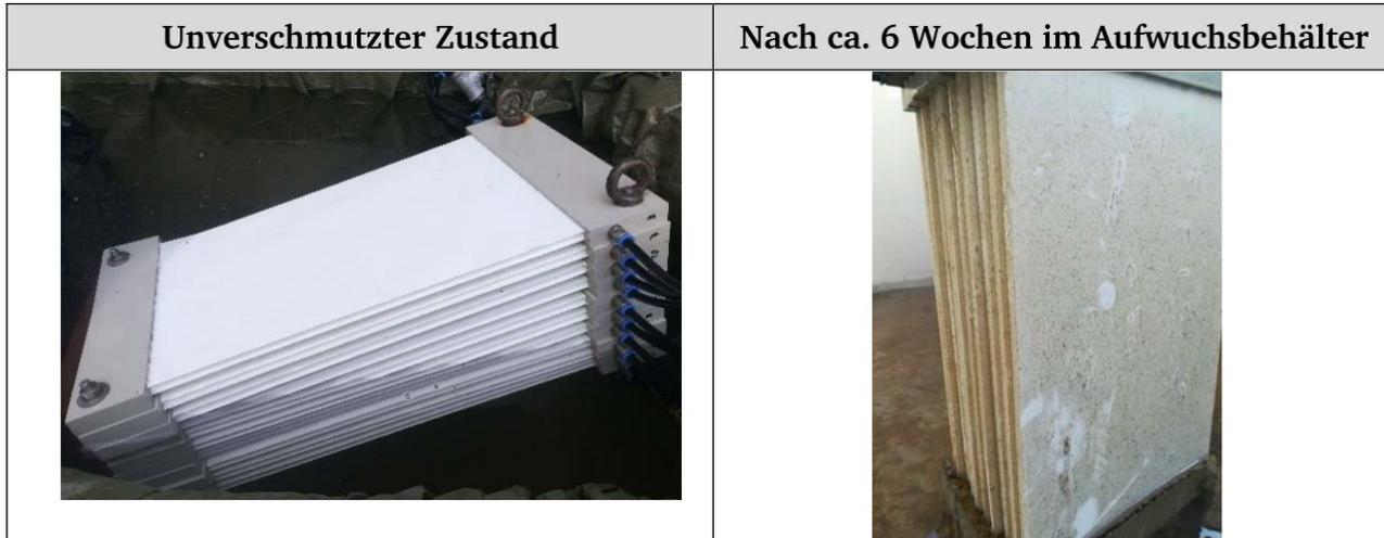
Abbildung 18: Optische Ablagerungsbildung am Beispiel des Wärmeübertragersystems „Stegplattenmuster“
