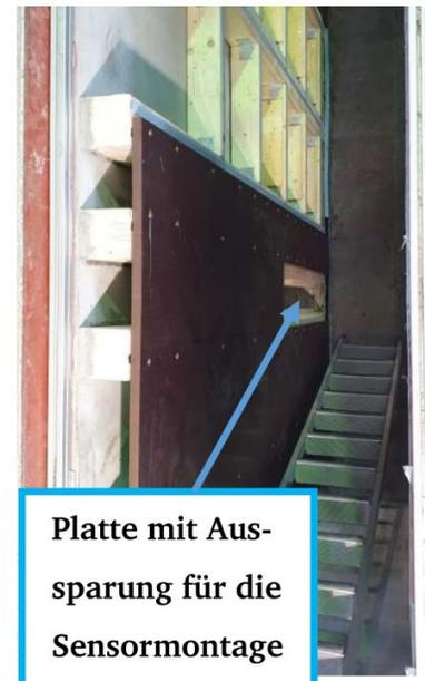
**Platte mit Aussparung für die Sensormontage**
