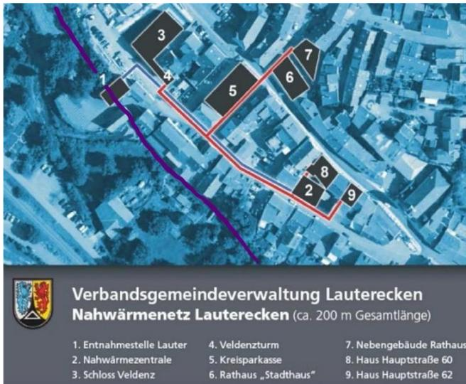
Abbildung 4: Nahwärmenetz Lauterecken (blau: Kaltleiter, rot: Wärmleiter, lila: Verlauf der Lauter) (Schwinghammer 2012)
