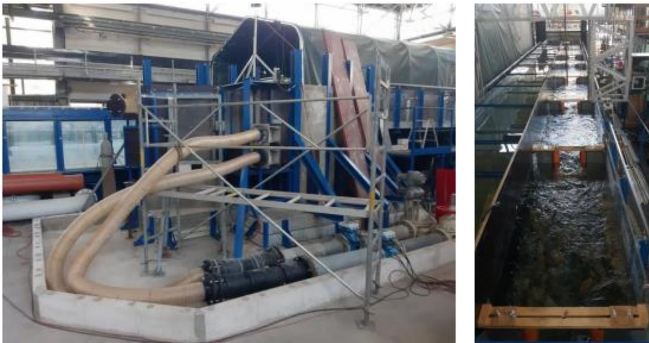
*Abbildung 40: Physikalisches Modell an der TU Darmstadt, links: Bereich Vorbecken mit Liftein- und Ausstiegen, rechts: Zulaufrinne mit strömungsbildenden Einbauten*
