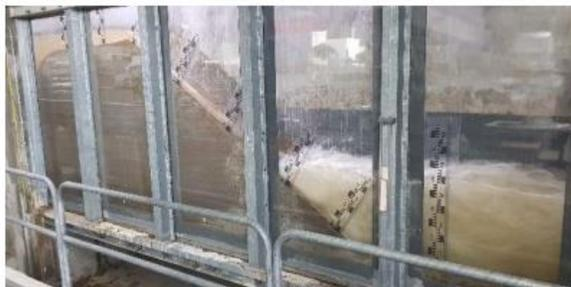
Überströmung mit landseitigem Wechselsprung
