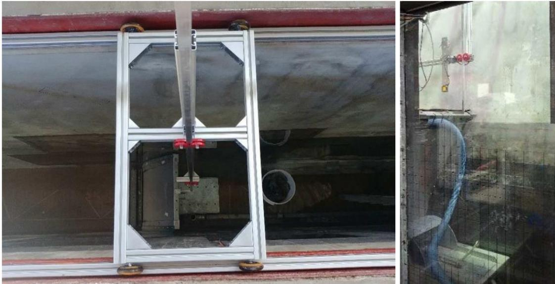
Abbildung 51: Messwagen folgt der Verschiebung der Überfallkante mittels vertikaler Linearführung auf dem seitlichen Schienensystem
