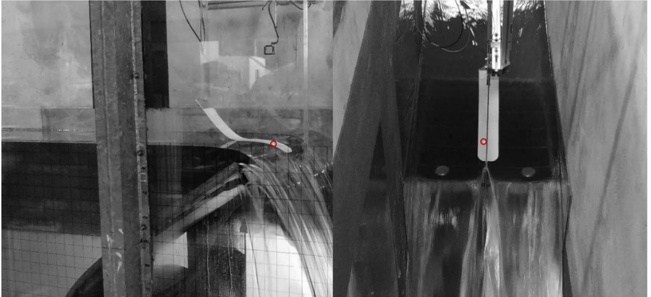
Abbildung 54: Berührungslose Messung der Wassertiefe an der Überfallkante mit Laser-Distanz-Sensor und schwimmenden Folienstreifen als Reflektor. Blickrichtung vom Beobachtungsraum (links) und von oben (rechts).
