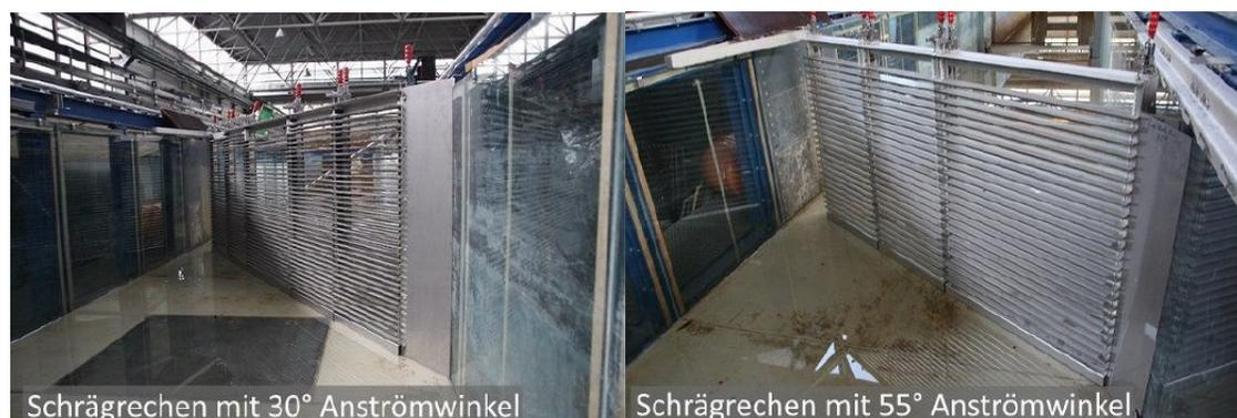
Abbildung 17: Geplante Setups des Schrägrechensystems (aus Berger, 2017: Rechenverluste und Auslegung von (elektrifizierten) Schrägrechen anhand ethohydraulischer Studien. Dissertation am FG Wasserbau und Hydraulik)
