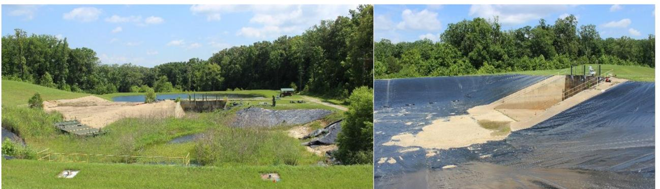
Abbildung 51: Versuchsdeich/-gelände bspw. zur Untersuchung von Hochwasserschutzmaßnahmen
