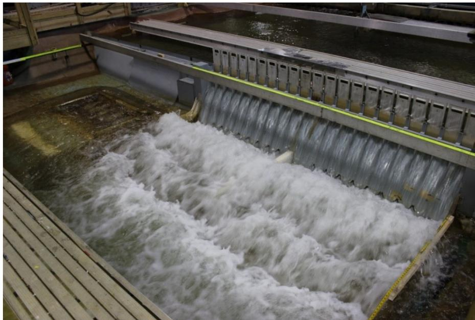
Abbildung 50: laufender Modellversuch zum Tosbecken am Bluestone Dam (bearbeitet von Dana W. Moses und seinem Team); Modellmaßstab: 1:65
